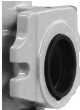
Soll die Pumpe mit einem Kupplungssystem in einem Schachteinbau verwendet werden (Zehnder Artikelnummer 12040), muss die Gummidichtung am Druckabgang entfernt werden, um eine dichte Verbindung zu erreichen!
