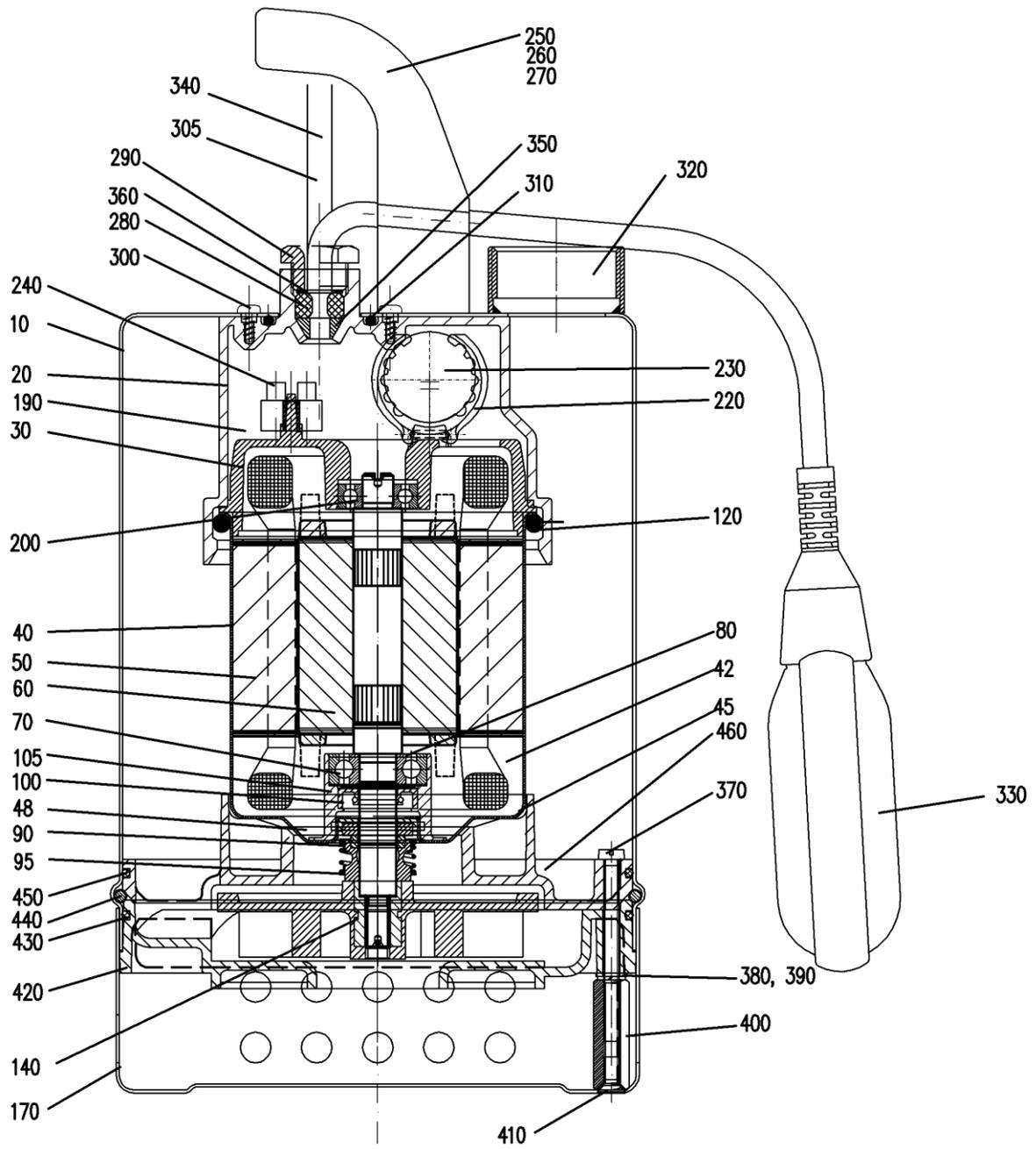
Ersatzteilzeichnung / Spare parts drawing / Dessin des pièces de rechange E-ZW 80 A
