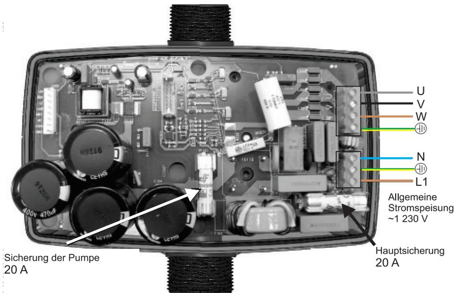
*Beim Anklemmen der Pumpe den Anschlussplan der Hauptplatine (im Boden des Reglers) beachten!*
