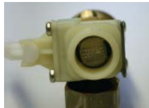
Siebeinsatz im Zulauf des Ventils eingesetzt
