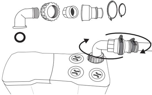
*Druckleitung Abgang mit 90° Bogen
