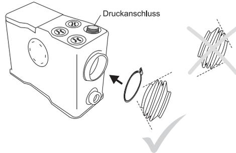
Dichtmuffe DN 85 (kleiner Durchmesser auf die Hebeanlage - größerer Durchmesser auf die Toilette) mit Schlauchschelle 80-100 am seitlichen Zulauf und mit Schlauchschelle 100-130 an der Toilette anbringen und Schellen festziehen.
