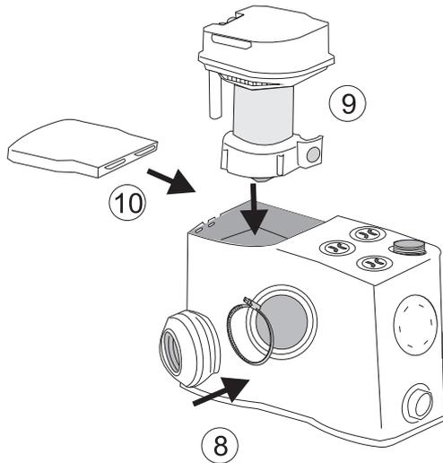
8. ▷ Dichtmuffe DN 85 und Schlauchschelle 80 - 100 vorne anbringen
