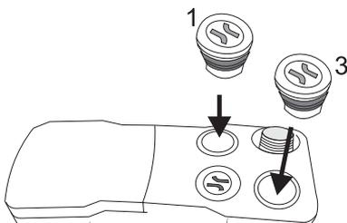
7. ▷ nun den Deckel mit Nr. 1 und den Deckel mit der Nr. 3 wieder auf die jeweilige Position setzen, beim Einsetzen auf die Geometrie der Geräteoberfläche achten
