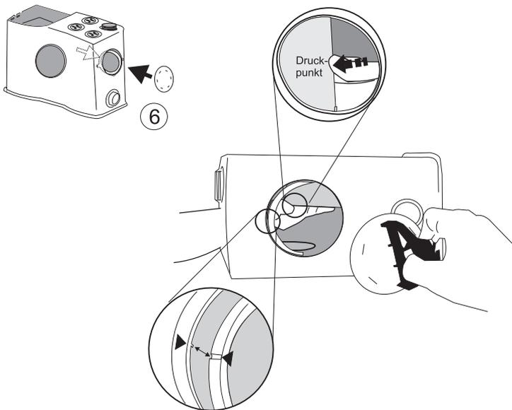
6. ▷ die innere Trennwand am Druckpunkt gehalten und so fixieren, dass die Nut des inneren Gewinderings am Steg in der Zulauföffnung einrastet. Jetzt kann der Deckel mit Hilfe des Spezialwerkzeugs eingedreht werden
