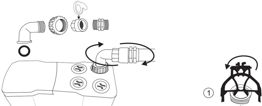
*Druckleitung Abgang mit 90° Bogen
