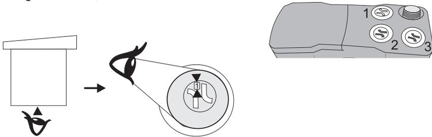
Im Auslieferungszustand befindet sich auf Position 1 die Entlüftung mit Aktivkohlefilter (kann getauscht werden ↪ Kap. 5.4.3 „Entlüftungsposition tauschen“)
