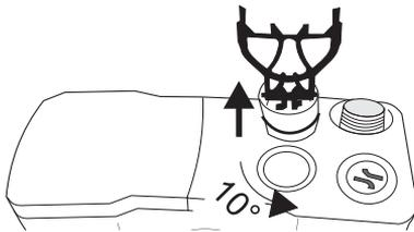
3. ▷ den inneren Zulauf nun mit Hilfe des Spezialwerkzeugs herausziehen dazu das Werkzeug in der Nut etwa 10° Grad gegen den Uhrzeigersinn drehen (spürbarer Widerstand) und nach oben ziehen
