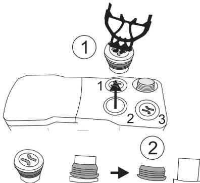
1. ▷ mit dem Spezialwerkzeug oberen Zulaufdeckel Pos.2 herausnehmen
