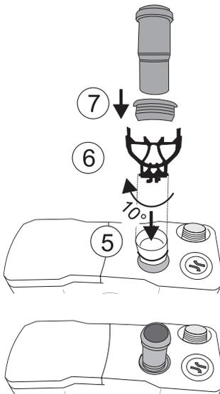
5. ▷ den geöffneten inneren Zulauf mit dem Spezialwerkzeug in der inneren Nut einsetzen
