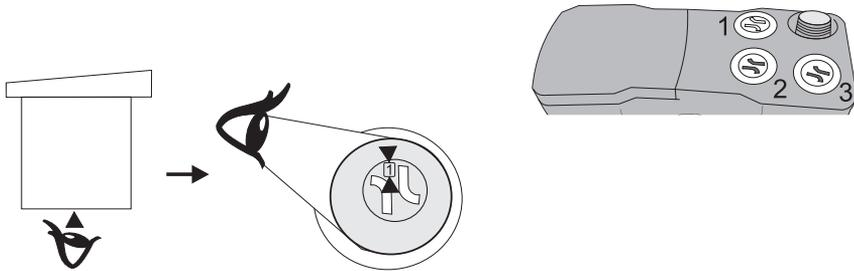
Im Auslieferungszustand befindet sich auf Position 1 die Entlüftung mit Aktivkohle. (kann getauscht werden ↪ Kap. 5.4.3 „Entlüftungsposition tauschen“)
