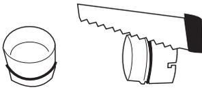
4. ▷ der innere Zulauf ist noch verschlossen mit einer Säge den Boden des Zulaufs aufschneiden
