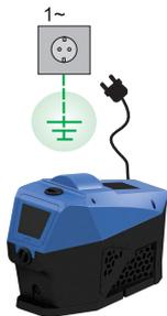
Die Pumpe muss an eine Steckdose mit Erdung angeschlossen werden (Zwangsbestimmung nach DIN VDE 100).
