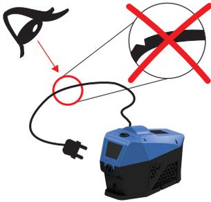
Die Pumpe darf nicht mit einem beschädigten Kabel in Betrieb genommen werden.
