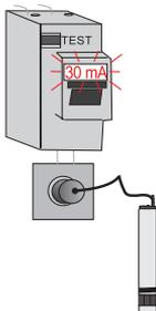
Sollte die Stromversorgung nicht obligatorisch über einen FI-Personenschutzschalter mit max. 30 mA Bemessungsfehlerstrom erfolgen, muss die Pumpe über einen separaten FI-Personenschutzschalter in der Steckdose angeschlossen werden (Zwangsbestimmung EN 60 335-2).
