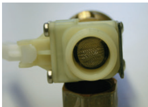
Siebeinsatz im Zulauf des Ventils eingesetzt
