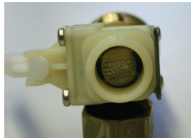
Siebeinsatz im Zulauf des Ventils eingesetzt
